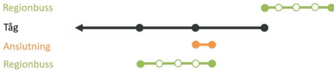
Figur 7: Trafikeringsprincip för regional busstrafik (med eller utan mellanliggande stopp) där tågtrafik saknas alternativt som komplement till tågtrafik på en delsträcka där efterfrågan är större än vad tågtrafiken tillgodoser i syfte att erbjuda bytesfria förbindelser där det annars krävs byten/anslutningar för att resa mellan de regionala målpunkterna
