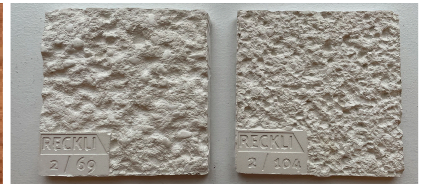
Betong med grövre struktur
